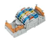
단면적 1.5 - 6 mm²의 무절단 케이블을 사용한 배전. PUSH IN 결선(0.5 - 10 mm²) 및/또는 플러그인 결선(0.5 -4mm²)을 통한 전원 공급/T-분기 탭.
