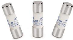
gPV 원통형 퓨즈 카트리지는 최대 전압 1,500 DC의 광전지 모듈(현장 보호)에 대해 컴팩트하고 안전하며, 경제적인 보호를 제공할 수 있도록 설계된 제품입니다. 과부하와 단락 보호를 모두 제공합니다(IEC60269-6 및 UL248-19 표준 요건에 따른 gPV 클래스). 높은 내부 압력과 열충격 내성을 가진 세라믹 튜브로 만들어져 좁은 공간에서도 높은 스위칭 용량을 갖습니다. 접점은 노화를 방지해 전기적 특성이 일정하게 유지되도록 하기 위해 은도금 구리와 순은의 가용성 요소로 만들었습니다. 10x38mm, 10x85mm, 22x58mm 사이즈로 접점을 사용할 수 있습니다.
