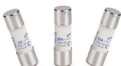
gPV 원통형 퓨즈 카트리지는 최대 전압 1,500 DC의 광전지 모듈(현장 보호)에 대해 컴팩트하고 안전하며, 경제적인 보호를 제공할 수 있도록 설계된 제품입니다. 과부하와 단락 보호를 모두 제공합니다(IEC60269-6 및 UL248-19 표준 요건에 따른 gPV 클래스). 높은 내부 압력과 열충격 내성을 가진 세라믹 튜브로 만들어져 좁은 공간에서도 높은 스위칭 용량을 갖습니다. 접점은 노화를 방지해 전기적 특성이 일정하게 유지되도록 하기 위해 은도금 구리와 순은의 가공성 요소로 만들었습니다. 10x38mm, 10x85mm, 22x58mm 사이즈로 접점을 사용할 수 있습니다.
