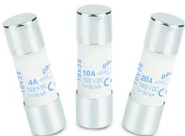
gPV 원통형 퓨즈 카트리지는 최대 전압 1,500 DC의 광전지 모듈(현장 보호)에 대해 컴팩트하고 안전하며, 경제적인 보호를 제공할 수 있도록 설계된 제품입니다. 과부하와 단락 보호를 모두 제공합니다(IEC60269-6 및 UL248-19 표준 요건에 따른 gPV 클래스). 높은 내부 압력과 열충격 내성을 가진 세라믹 튜브로 만들어져 좁은 공간에서도 높은 스위칭 용량을 갖습니다. 접점은 노화를 방지해 전기적 특성이 일정하게 유지되도록 하기 위해 은도금 구리와 순은의 가용성 요소로 만들었습니다. 10x38mm, 10x85mm, 22x58mm 사이즈로 접점을 사용할 수 있습니다.
