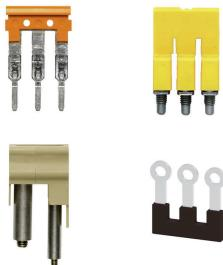
인접한 단자대에 전위를 분배 또는 증가시키는 것은 교차 연결을 통해 구현됩니다. 추가적인 결선 노력을 쉽게 피할 수 있습니다. 폴이 분리되더라도 단자대 블록의 접점 안정성은 여전히 보장됩니다. 당사의 포트폴리오는 모듈형 터미널 블록을 위한 플러그형 및 스크루형 점프바 시스템을 제공합니다.
