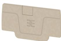
종판과 엔드 플레이트는 단자대의 필수 부속품입니다. 종판은 서로 다른 전위와 기능 그룹을 광학적으로 및 전기적으로 분리하여 안전성을 높이고 배전반 내부의 명확한 구조를 보장합니다. 엔드 플레이트는 측면의 단자대 열을 마감하고, 전류가 흐르는 부품과의 접촉을 방지하며, 깔끔하고 안정적인 마감을 보장합니다. 두 부품 모두 각각의 바이드룰러 단자대 시리즈에 정확히 대응되어 안전하고 규정을 준수하며 전문적인 배선에 기여합니다.
