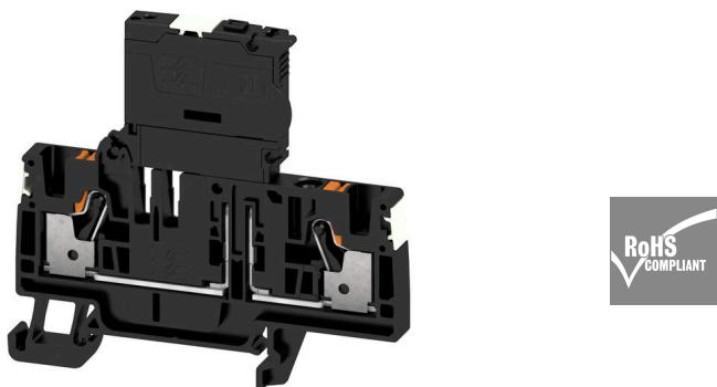
퓨즈 단자대 및 부품 단자대는 보호 및 기능 요소를 단자대에 직접 통합할 수 있게 합니다. 퓨즈 단자대는 내장형 퓨즈 홀더를 포함하여 전기 회로를 과부하로부터 안정적으로 보호하며 제어 및 분배기 레일 시스템에 이상적입니다. 부품 단자대는 다이오드, 저항기 또는 LED와 같은 전자 부품을 배선에 직접 통합할 수 있게 합니다. 이를 통해 공간 절약형이며 명확하게 배열된 스위칭 기능 및 신호 분리를 구현할 수 있습니다. 두 유형의 단자대 모두 높은 안전성, 쉬운 유지보수 및 기능 중심의 컴팩트한 설치를 보장합니다.
