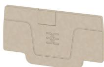
종판과 엔드 플레이트는 단자대의 필수 부속품입니다. 종판은 서로 다른 전위와 기능 그룹을 광학적으로 및 전기적으로 분리하여 안전성을 높이고 배전반 내부의 명확한 구조를 보장합니다. 엔드 플레이트는 측면의 단자대 열을 마감하고, 전류가 흐르는 부품과의 접촉을 방지하며, 깔끔하고 안정적인 마감을 보장합니다. 두 부품 모두 각각의 바이드뮬러 단자대 시리즈에 정확히 대응되어 안전하고 규정을 준수하며 전문적인 배선에 기여합니다.
