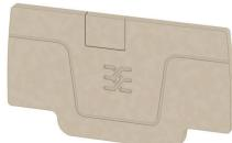
종판과 엔드 플레이트는 단자대의 필수 부속품입니다. 종판은 서로 다른 전위와 기능 그룹을 광학적으로 및 전기적으로 분리하여 안전성을 높이고 배전반 내부의 명확한 구조를 보장합니다. 엔드 플레이트는 측면의 단자대 열을 마감하고, 전류가 흐르는 부품과의 접촉을 방지하며, 깔끔하고 안정적인 마감을 보장합니다. 두 부품 모두 각각의 바이드뮬러 단자대 시리즈에 정확히 대응되어 안전하고 규정을 준수하며 전문적인 배선에 기여합니다.
