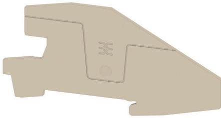
종판과 엔드 플레이트는 단자대의 필수 부속품입니다. 종판은 서로 다른 전위와 기능 그룹을 광학적으로 및 전기적으로 분리하여 안전성을 높이고 배전반 내부의 명확한 구조를 보장합니다. 엔드 플레이트는 측면의 단자대 열을 마감하고, 전류가 흐르는 부품과의 접촉을 방지하며, 깔끔하고 안정적인 마감을 보장합니다. 두 부품 모두 각각의 바이드물러 단자대 시리즈에 정확히 대응되어 안전하고 규정을 준수하며 전문적인 배선에 기여합니다.
