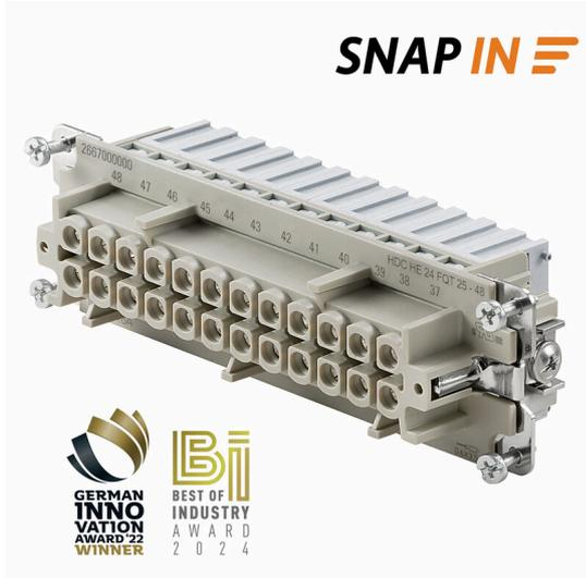
SNAP IN 결선 방식을 적용해 컨덕터 결선 레벨이 이미 개방되어 있어 탈피된 커넥터의 간편한 삽입이 가능합니다. 최종 위치에서는 특허받은 클램핑 메커니즘을 통해 자동으로 닫힙니다. 따라서 관리가 거의 필요 없고 안전하며 영구적, 진동 방지 결선을 구현했습니다. 바이드물러는 이처럼 최초이자 유일하게 혁신적 결선 시스템을 제공하고 있는 제조업체입니다.
