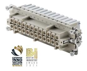
SNAP IN 결선 방식을 적용해 컨덕터 결선 레벨이 이미 개방되어 있어 탈피된 커넥터의 간편한 삽입이 가능합니다. 최종 위치에서는 특허받은 클램핑 메커니즘을 통해 자동으로 닫힙니다. 따라서 관리가 거의 필요 없고 안전하며 영구적, 진동 방지 결선을 구현했습니다. 바이드뮬러는 이처럼 최초이자 유일하게 혁신적 결선 시스템을 제공하고 있는 제조업체입니다.
