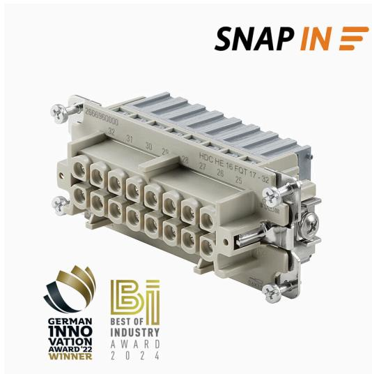
SNAP IN 결선 방식을 적용해 컨ектор 결선 레벨이 이미 개방되어 있어 탈피된 커넥터의 간편한 삽입이 가능합니다. 최종 위치에서는 특허받은 클램핑 메커니즘을 통해 자동으로 닫힙니다. 따라서 관리가 거의 필요 없고 안전하며 영구적, 진동 방지 결선을 구현했습니다. 바이드뮬러는 이처럼 최초이자 유일하게 혁신적 결선 시스템을 제공하고 있는 제조업체입니다.
