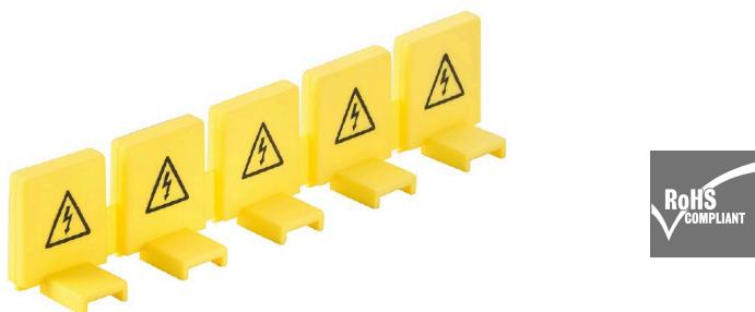
엔드 캡 및 커버는 버스 바를 길이로 절단한 후 또는 독립형 접점인 경우에도 시스템에서 필요한 연면 거리를 보장하며, DIN EN 50274에 따라 손가락 안전을 보장합니다.
