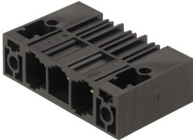
단층, 고전류 수형 헤더, 폴 손실이 없거나 공구 없이 빠른 잡금을 위한 특허 받은 플랜지를 사용한 병렬 장착용. 잘못된 결선을 방지하는 짹을 이루는 형태 덕분에 실현된 최대의 결선 및 작동 신뢰성과 특유의 다양한 코딩. 플랜지의 추가 조임. 3.5 mm 핀 길이는 웨이브 솔더링에 최적화되어 있으며, 플러그인 방향은 솔더 핀에 대해 90°입니다.
