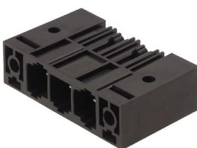
단층, 고성능 수형 헤더, 폴 손실이 없거나 공구 없이 빠른 고정을 위한 특허를 받은 플랜지를 사용한 병렬 장착용. 잘못된 결선을 방지하는 짹을 이루는 형태 덕분에 실현된 최대의 결선 및 작동 신뢰성과 특유의 다양한 코딩. 플랜지의 추가 조임. 3.5 mm 핀 길이는 웨이브 솔더링에 최적화되어 있으며, 플러그인 방향은 솔더 핀에 대해 270°입니다.
