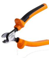
최대 외경 8 mm, 12 mm, 14 mm 및 22 mm 컨덕터용 절단 공구. 블레이드의 특수 기하학적 구조로 인해 최소한의 물리적 힘으로 구리 및 알루미늄 컨덕터를 핀침 없이 절단할 수 있습니다. 이 절단 공구(KT 8~KT 22)는 VDE 및 GS 시험을 통과한 EN/IEC 60900 규격의 보호 절연(최대 1,000V)도 제공합니다.
