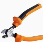
최대 외경 8 mm, 12 mm, 14 mm 및 22 mm 컨덕터용 절단 공구. 블레이드의 특수 기하학적 구조로 인해 최소한의 물리적 힘으로 구리 및 알루미늄 컨덕터를 핀침 없이 절단할 수 있습니다. 이 절단 공구(KT 8~KT 22)는 VDE 및 GS 시험을 통과한 EN/IEC 60900 규격의 보호 절연(최대 1,000V)도 제공합니다.
