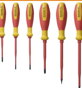
VDE 절연 스크류드라이버 세트, 최대 1000 V AC 및 1500 V DC의 전류가 흐르는 부품에서 작업 가능, DIN EN 60900, IEC 900. 각 세트 피스는 "GS" 안전 검증을 받음. 완전 강화 고합금 크로미움-바나디움-몰리브덴 스틸 재질의 블레이드, 건 메탈 마감.
