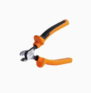
최대 외경 8 mm, 12 mm, 14 mm 및 22 mm 컨덕터용 절단 공구. 블레이드의 특수 기하학적 구조로 인해 최소한의 물리적 힘으로 구리 및 알루미늄 컨덕터를 핀칭 없이 절단할 수 있습니다. 이 절단 공구(KT 8~KT 22)는 VDE 및 GS 시험을 통과한 EN/IEC 60900 규격의 보호 절연(최대 1,000V)도 제공합니다.
