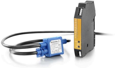
Rogowski 코일 Rogowski 코일은 강자성 코어가 없는 폐쇄형 공기 코일로, AC와 펄스 전류의 부유 전위 측정 용도로 사용됩니다. Rogowski 코일을 사용한 측정 방식은 기존 시스템의 일차적 전기 회로를 분리할 필요 없이 소급적 결합이 가능하기 때문에 기술 분야에서 널리 사용됩니다. 이 방식에서는 포화 효과가 전혀 나타나지 않기 때문에 극소량의 전류와 고주파 고조파(harmonics)도 정확성 손실 없이 측정 가능합니다.
