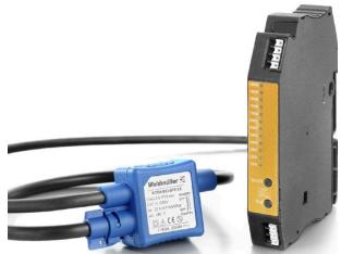
Rogowski 코일 Rogowski 코일은 강자성 코어가 없는 펴 쇄형 공기 코일로, AC와 펄스 전류의 부유 전위 측정 용도로 사용됩니다. Rogowski 코일을 사용한 측정 방식은 기존 시스템의 일차적 전기 회로를 분리할 필요 없이 소급적 결합이 가능하기 때문에 기술 분야에서 널리 사용됩니다. 이 방식에서는 포화 효과가 전혀 나타나지 않기 때문에 극소량의 전류와 고주파 고조파(harmonics)도 정확성 손실 없이 측정 가능합니다.
