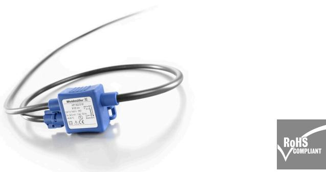
Rogowski 코일 Rogowski 코일은 강자성 코어가 없는 페 쇄형 공기 코일로, AC와 펄스 전류의 부유 전위 측정 용도로 사용됩니다. Rogowski 코일을 사용한 측정 방식은 기존 시스템의 일차적 전기 회로를 분리할 필요 없이 소급적 결합이 가능하기 때문에 기술 분야에서 널리 사용됩니다. 이 방식에서는 포화 효과가 전혀 나타나지 않기 때문에 극소량의 전류와 고주파 고조파(harmonics)도 정확성 손실 없이 측정 가능합니다.
