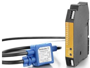
Rogowski 코일 Rogowski 코일은 강자성 코어가 없는 펴 쇠형 공기 코일로, AC와 펄스 전류의 부유 전위 측정 용도로 사용됩니다. Rogowski 코일을 사용한 측정 방식은 기존 시스템의 일차적 전기 회로를 분리할 필요 없이 소급적 결합이 가능하기 때문에 기술 분야에서 널리 사용됩니다. 이 방식에서는 포화 효과가 전혀 나타나지 않기 때문에 극소량의 전류와 고주파 고조파(harmonics)도 정확성 손실 없이 측정 가능합니다.
