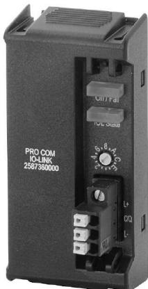
바이드뮬러의 플러그 입력 통신 모듈은 개별 구성 요소가 클라우드로 관련 데이터를 교환할 수 있도록 합니다. 이는 효율성, 품질, 프로세스 안정성 및 가용성 증가에 결정적인 역할을 하는 요소인 상태 모니터링 및 원격 제어성을 사용하여 목표 프로세스 최적화의 토대를 마련합니다. 통신 모듈은 IP20 보호에 따라 설계되었으며, 공구 없이 동작할 수 있고 다른 맞춤형 통신 프로토콜에 유연하게 적응할 수 있습니다.
