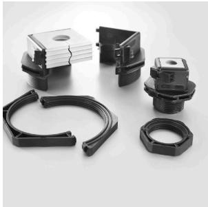
메트릭 규격 M20~M36 관통 구멍을 위해 Cabtite 케이블 인입 시스템은 케이블의 플러그 유무에 관계 없이 분리형 케이블 글랜드를 제공합니다. 유지 보수 또는 시스템 변경시 직경 2~35mm의 선조립 케이블을 패널이나 인클로저에 신속하고 안전하게 삽입할 수 있습니다. DIN EN 60529에 따른 신뢰도 높은 IP66 실링과 절대적으로 안전한 장착(DIN EN 62444 규격 스트레인 릴리프)는 웨이브 커이 적용된 슬롯형 실링 요소를 케이블에 장착한 후 케이블 글랜드를 2등분한 두 개 중 하나에 삽입함으로써 보장됩니다. 분리형 시스템 인클로저를 채용하여 간편하고 신속한 설치를 보장합니다. 실링 요소를 삽입한 후, 케이블 글랜드의 2등분한 부분은 간편하게 끼워 연결됩니다. 패널 내부의 분리 가능한 잠금너트는 신뢰할 수 있고 안전한 고정을 보장합니다.
