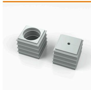
Cabtite는 케이블 직경에 구애받지 않고 언제나 적합한 실 인서트를 제공합니다. 씰링 요소는 원뿔 형태로 되어 있어 기존에 배치되어 있는 스냅인 방식을 그리드 인레이를 안에서 밖으로 쉽게 밀어낼 수 있습니다. 중간 공간을 확실하게 밀봉해 주고 DIN EN 62444에 따라 스트레인 해소 기능을 제공합니다. 씰 인서트는 프레임과 함께 IP 66 등급의 보호를 제공합니다. 웨이브 절삭 가공된 슬롯형 디자인으로 인해 선조립 케이블에 특히 적합합니다.
