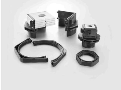
메트릭 규격 M20~M36 관통 구멍을 위해 Cabtite 케이블 인입 시스템은 케이블의 플러그 유무에 관계 없이 분리형 케이블 글랜드를 제공합니다. 유지 보수 또는 시스템 변경시 직경 2~35mm의 선조립 케이블을 패널이나 인클로저에 신속하고 안전하게 삽입할 수 있습니다. DIN EN 60529에 따른 신뢰도 높은 IP66 실링과 절대적으로 안전한 장착(DIN EN 62444 규격 스트레인 릴리프)는 웨이브 컷이 적용된 슬롯형 실링 요소를 케이블에 장착한 후 케이블 글랜드를 2등분한 두 개 중 하나에 삽입함으로써 보장됩니다. 분리형 시스템 인클로저를 채용하여 간편하고 신속한 설치를 보장합니다. 실링 요소를 삽입한 후, 케이블 글랜드의 2등분한 부분은 간편하게 끼워 연결됩니다. 패널 내부의 분리 가능한 잠금너트는 신뢰할 수 있고 안전한 고정을 보장합니다.
