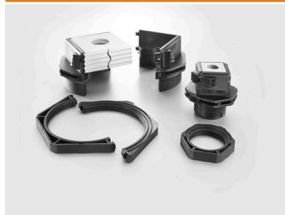
메트릭 규격 M20~M36 관통 구멍을 위해 Cabtite 케이블 인입 시스템은 케이블의 플러그 유무에 관계 없이 분리형 케이블 글랜드를 제공합니다. 유지 보수 또는 시스템 변경시 직경 2~35mm의 선조립 케이블을 패널이나 인클로저에 신속하고 안전하게 삽입할 수 있습니다. DIN EN 60529에 따른 신뢰도 높은 IP66 실링과 절대적으로 안전한 장착(DIN EN 62444 규격 스트레인 릴리프)는 웨이브 커이 적용된 슬롯형 실링 요소를 케이블에 장착한 후 케이블 글랜드를 2등분한 두 개 중 하나에 삽입함으로써 보장됩니다. 분리형 시스템 인클로저를 채용하여 간편하고 신속한 설치를 보장합니다. 실링 요소를 삽입한 후, 케이블 글랜드의 2등분한 부분은 간편하게 끼워 연결됩니다. 패널 내부의 분리 가능한 잠금너트는 신뢰할 수 있고 안전한 고정을 보장합니다.
