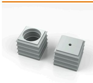
Cabtite는 케이블 직경에 구애받지 않고 언제나 적합한 실 인서트를 제공합니다. 실링 요소는 원뿔 형태로 되어 있어 기존에 배치되어 있는 스냅인 방식을 그리드 인레이를 안에서 밖으로 쉽게 밀어낼 수 있습니다. 중간 공간을 확실하게 밀봉해 주고 DIN EN 62444에 따라 스트레인 해소 기능을 제공합니다. 실 인서트는 프레임과 함께 IP 66 등급의 보호를 제공합니다. 웨이브 절삭 가공된 슬롯형 디자인으로 인해 선조립 케이블에 특히 적합합니다.
