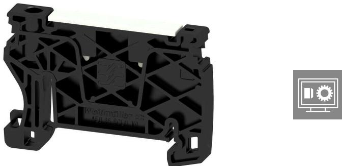
바이드뮬러 제품군에는 단자대 레일에 영구적이고 안정적으로 마운트될 수 있도록 보장하고 미끄러짐을 방지하는 엔드 브래킷이 포함되어 있습니다. 스크류가 포함 또는 포함되지 않은 버전을 사용할 수 있습니다. 엔드 브래킷에는 마킹 옵션(그룹 마커용 포함)과 테스트 플러그 홀더가 포함되어 있습니다.
