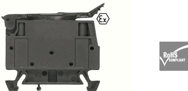
퓨즈 단자대 및 부품 단자대는 보호 및 기능 요소를 단자대에 직접 통합할 수 있게 합니다. 퓨즈 단자대는 내장형 퓨즈 홀더를 포함하여 전기 회로를 과부하로부터 안정적으로 보호하며 제어 및 분배기 레일 시스템에 이상적입니다. 부품 단자대는 다이오드, 저항기 또는 LED와 같은 전자 부품을 배선에 직접 통합할 수 있게 합니다. 이를 통해 공간 절약형이며 명확하게 배열된 스위칭 기능 및 신호 분리를 구현할 수 있습니다. 두 유형의 단자대 모두 높은 안전성, 쉬운 유지보수 및 기능 중심의 컴팩트한 설치를 보장합니다.
