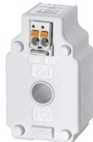
CMA-CTM 7 시리즈 미니 전류 변압기는 유도형 전류 변압기로, 원형 1차 컨덕터용 변압기 원칙에 따라 설계된 제품입니다. CMA-CTM 7 시리즈 전류 변압기는 유지보수가 필요 없고 32A부터 64A 범위에서 1차 전류를 측정하도록 설계된 제품입니다. 이 전류는 2차측에서 최대 1A의 전류로 변환됩니다. 크기가 작아 상 분리가 17.5mm인 3상 회로 차단기 내 사용 용도로 이상적입니다.
