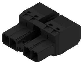
피치가 7.62인 6 mm<sup>2</sup>의 현장 배선을 위한 PUSH IN 결선 기술을 탑재한 180° 역방향 역전압에 안전한 수형 헤더 7.62 피치로 6 mm<sup>2</sup>의 현장 배선을 위한 자동 잠금식 중간 플랜지 포함.
