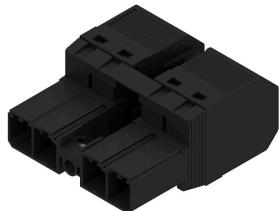
피치가 7.62인 6 mm<sup>2</sup>의 현장 배선을 위한 PUSH IN 결선 기술을 탑재한 180° 역방향 역전압에 안전한 수형 헤더 7.62 피치로 6 mm<sup>2</sup>의 현장 배선을 위한 자동 잠금식 중간 플랜지 포함. 역방향 전압에 대해 접촉 보호 솔루션으로도 이상적입니다. UL1059 600 V 클래스 C 및 IEC 61800-5-1의 요구사항을 충족합니다. 요청 시 중간 플랜지 없이 제공 가능합니다.
