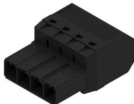
간선 관통용 "3개 플랜지 기종"으로서 7.62 피치 6 mm 필드 배선 PUSH IN 결선 기술이 탑재된 180° 역방향 핀헤더 벽 두께가 최대 2 mm인 인클로저에 적합. 역방향 전압에 대한 접촉 안전 솔루션으로도 최적입니다.
