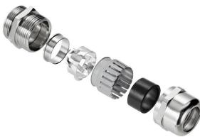
전자 콤파넌트의 감도가 높아지고 전자기 간섭 주파수가 들어남에 따라 케이블 글랜드는 시스템의 차폐 측면에서 중요한 역할을 하고 있습니다. 이러한 유형의 EMC 케이블 글랜드는 360° 스크리닝 결선을 이용해 간섭 주파수로부터 차폐 기능을 발휘하도록 제작되었습니다. 핑거 록킹 씰이 탁월한 케이블 유지 및 스트레인 릴리프 기능을 제공하며, 그 옆의 케이블 글랜드는 EN 62444의 기계적 요구 사항을 충족합니다. 특히 받은 설계로 매우 간편하고 신속한 조립이 가능합니다.
