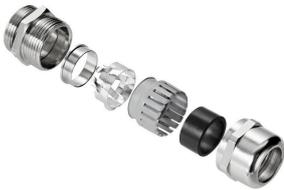
전자 컴포넌트의 감도가 높아지고 전자기 간섭 주파수가 늘어남에 따라 케이블 글랜드는 시스템의 차폐 측면에서 중요한 역할을 하고 있습니다. 이러한 유형의 EMC 케이블 글랜드는 360° 스크리닝 결선을 이용해 간섭 주파수로부터 차폐 기능을 발휘하도록 제작되었습니다. 핑거 록킹 씰이 탁월한 케이블 유지 및 스트레인 릴리프 기능을 제공하며, 그 옆의 케이블 글랜드는 EN 62444의 기계적 요구 사항을 충족합니다. 특히 받은 설계로 매우 간편하고 신속한 조립이 가능합니다.
