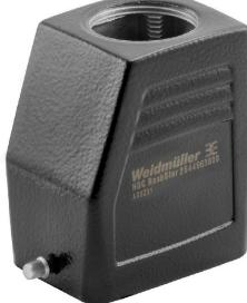
신제품 바이드뮬러 RockStar® IP65 EMV 인클로저는 가장 혹독한 환경 조건에서도 사용하기 적합한 제품으로 전자기장 간섭 보호 기능을 갖추고 있습니다. 고내구성 커넥터는 커넥터 인서트와 보호 하우징으로 구성되어 있습니다. 신제품 플라스틱 스트랩은 간편하게 잠글 수 있고 언제든지 교체 가능합니다. 모든 바이드뮬러 RockStar® 인클로저는 고품질 금형 주조 알루미늄으로 제작됩니다. 따라서 크기가 작고 가벼우면서도 충격과 부식에 강합니다.
