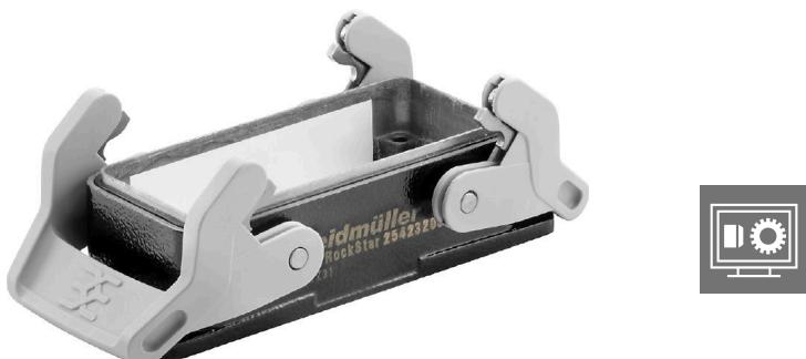
신제품 바이드뮬러 RockStar® IP65 EMV 인클로저는 가장 혹독한 환경 조건에서도 사용하기 적합한 제품으로 전자기장 간섭 보호 기능을 갖추고 있습니다. 고내구성 커넥터는 커넥터 인서트와 보호 하우징으로 구성되어 있습니다. 신제품 플라스틱 스트랩은 간편하게 잡을 수 있고 언제든지 교체 가능합니다. 모든 바이드뮬러 RockStar® 인클로저는 고품질 금형 주조 알루미늄으로 제작됩니다. 따라서 크기가 작고 가벼우면서도 충격과 부식에 강합니다.
