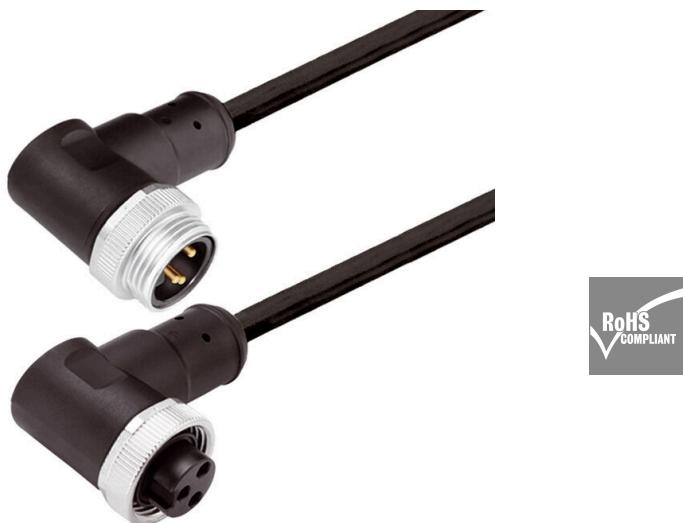
센서/액추에이터 케이블은 다양한 용도에서 센서와 액추에이터를 배선하고 데이터 또는 동력을 전달하는 데 사용됩니다. 주조된 케이블은 테스트를 통해 입증된 플러그 커넥터 결선을 제공합니다. 케이블은 습도, 먼지, 열, 냉기, 충격, 진동과 같은 다양한 조건에 노출될 수 있습니다. 7/8" 케이블은 주로 전원 공급용으로 사용됩니다. 찾을 수 없거나 설명이 필요한 정보가 있습니까? 저희에게 알려 주십시오!
