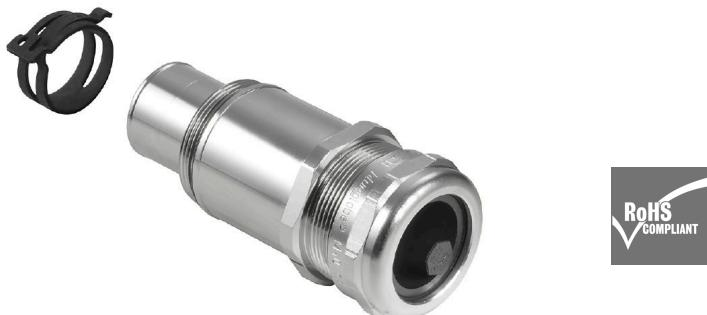
전자 콤파넌트의 감도가 높아지고 전자기 간섭 주파수가 늘어남에 따라 케이블 글랜드는 시스템의 차폐 측면에서 중요한 역할을 하고 있습니다. 이러한 유형의 EMC 케이블 글랜드는 360° 스크리닝 결선을 이용해 간섭 주파수로부터 차폐 기능을 발휘하도록 제작되었습니다. 핑거 롤링 씰이 탁월한 케이블 유지 및 스트레이인 릴리프 기능을 제공하며, 그 옆의 케이블 글랜드는 EN 62444의 기계적 요구 사항을 충족합니다. 특히 받은 설계로 매우 간편하고 신속한 조립이 가능합니다.
