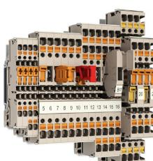
일부 응용 분야에서는 테스트 및 안전 목적을 위해 기본 연결 단자대에 테스트 포인트 또는 분리 요소를 추가하는 것이 좋습니다. 테스트 분리 단자대를 사용하여 전압이 없을 때 전기 회로를 측정할 수 있습니다. 분리 지점 이격 및 연면 거리는 치수와 관련하여 평가되지 않지만, 지정된 정격 임펄스 전압 강도를 입증해야 합니다.
