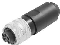
최근에는 각각 다양한 길이의 케이블이 종종 필요합니다. 이러한 요구를 충족할 수 있도록 바이드뮬러에서는 맞춤형 어셈블리를 위한 다양한 플러그 커넥터를 제공합니다. M8, M12, M16 및 7/8" 결선(탁월한 견고성으로 머신 엔지니어링 등에 이상적임)용 맞춤형 어셈블리를 위한 수형 플러그와 암형 소켓. 7/8" 원형 플러그 커넥터는 많은 양의 전력을 송전할 수 있습니다. 스크류 결선은 광범위한 용도에 사용할 수 있습니다. 이 결선은 전선(선택적으로 페럴 사용)을 결선 요소에 끼우고 스크류로 조이는 방식입니다. 가장 경제적이고 일반적인 결선 방식으로, 이 방식은 다중 도체에 대한 결선도 지원합니다.
