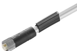
고객님의 주변 기기는 더 높은 전원 공급이 있어야 합니다. 당사의 신형 M12 플러그인 커넥터가 있으면 250 V 및 2 A 이상을 원활하게 공급할 수 있습니다. 컴팩트한 A, K, L, S, T 코딩 M12 플러그인 커넥트는 최대 630 V AC 또는 60 V DC 및 12 A의 전송을 위해 설계되었습니다.
