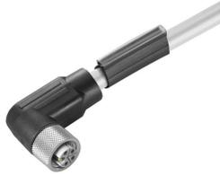
고객님의 주변 기기는 더 높은 전원 공급이 있어야 합니다. 당사의 신형 M12 플러그인 커넥터가 있으면 250 V 및 2 A 이상을 원활하게 공급할 수 있습니다. 컴팩트한 A, K, L, S, T 코딩 M12 플러그인 커넥트는 최대 630 V AC 또는 60 V DC 및 12 A의 전송을 위해 설계되었습니다.
