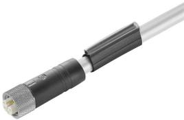
고객님의 주변 기기는 더 높은 전원 공급이 있어야 합니다. 당사의 신형 M12 플러그인 커넥터가 있으면 250 V 및 2 A 이상을 원활하게 공급할 수 있습니다. 컴팩트한 A, K, L, S, T 코딩 M12 플러그인 커넥트는 최대 630 V AC 또는 60 V DC 및 12 A의 전송을 위해 설계되었습니다.
