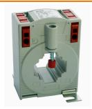
플러그온 전류 변압기 플러그온 전류 변압기는 최대 5000A의 고전류를 측정하고 처리해야 하는 모든 곳에 사용됩니다. 당사의 플러그온 전류 변압기는 1A 또는 5A의 2차 전류를 공급합니다. 바이드뮬러는 또한 최대 600A의 전류를 최대 333mV의 전압으로 변환하는 컴팩트형 저전력 전류 변압기를 제공합니다.
