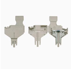
컴포넌트 플러그는 분리 단자대 블록에 전기 컴포넌트를 통합하는 데 사용됩니다. 전자 컴포넌트를 납땜한 후 플러그를 분리 단자대 블록의 분리 영역에 통합할 수 있으므로 분리 단자대 블록을 전자 부품이 통합된 모듈식 단자대로 변경합니다.
