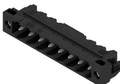
내열성 핀 헤더, 상자 또는 테이프로 포장됨. 자동 조립에 최적화된 1.5 mm 용접 핀의 테이프 형태. 리플로우 및 웨이브 용접에 적합한 3.2 mm 솔더 핀. 핀 헤더는 라벨링을 위한 공간을 제공하며 코딩이 가능합니다. HC = 고전류
