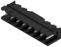
90° 각도의 내고운 개방형 수형 헤더 박스 또는 테이프 포장. 자동 조립에 최적화된 1.5 mm 용접 핀의 테이프 형태. 리플로우 및 웨이브 용접에 적합한 3.2 mm 솔더 핀. 핀 헤더는 라벨링을 위한 공간을 제공하며 코딩이 가능합니다. HC = 고전류
