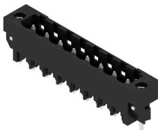
내열성 핀 헤더, 상자 또는 테이프로 포장됨. 자동 조립에 최적화된 1.5 mm 용접 핀의 테이프 형태. 리플로우 및 웨이브 용접에 적합한 3.2 mm 솔더 핀. 핀 헤더는 라벨링을 위한 공간을 제공하며 코딩이 가능합니다. HC = 고전류
