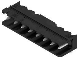
90° 각도의 내고운 개방형 수형 헤더 박스 또는 테이프 포장. 자동 조립에 최적화된 1.5 mm 용접 핀의 테이프 형태. 리플로우 및 웨이브 용접에 적합한 3.2 mm 솔더 핀. 핀 헤더는 라벨링을 위한 공간을 제공하며 코딩이 가능합니다. HC = 고전류
