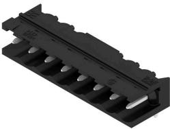
90° 각도의 내고온 개방형 수형 헤더 박스 또는 테이프 포장. 자동 조립에 최적화된 1.5 mm 용접 핀의 테이프 형태. 리플로우 및 웨이브 용접에 적합한 3.2 mm 솔더 핀. 핀 헤더는 라벨링을 위한 공간을 제공하며 코딩이 가능합니다. HC = 고전류
