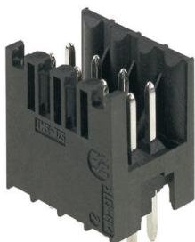
모든 공통 용접 방식을 위한 내고온성 이중 핀 헤더. 자동 조립에 최적화. 박스 또는 테이프 포장. 리플로우 및 웨이브 용접에 적합한 3.2 mm 길이 솔더 핀. 수형 커넥터에는 라벨링을 위한 공간이 있으며 코딩이 가능합니다.
