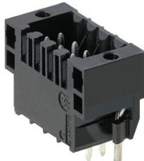
모든 공통 용접 방식을 위한 내고온성 이중 핀 헤더. 자동 조립에 최적화. 박스 또는 테이프 포장. 리플로우 및 웨이브 용접에 적합한 3.2 mm 길이 솔더 핀. 수형 커넥터에는 라벨링을 위한 공간이 있으며 코딩이 가능합니다.
