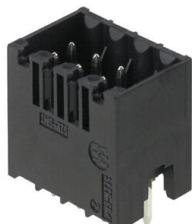
모든 공통 용접 방식을 위한 내고온성 이중 핀 헤더. 자동 조립에 최적화. 박스 또는 테이프 포장. 리플로우 및 웨이브 용접에 적합한 3.2 mm 길이 솔더 핀. 수형 커넥터에는 라벨링을 위한 공간이 있으며 코딩이 가능합니다.
