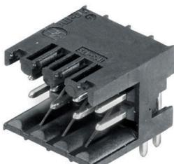
내열성, 직선, 모든 일반 솔더링 방법을 위한 2층 핀 헤더. 자동 조립에 최적화되어 있음. 박스 또는 테이프로 포장됨. 리플로우 및 웨이브 솔더링에 적합한 3.2 mm 솔더 핀. 이 핀 헤더는 라벨링 및 코딩될 수 있음. (요청 시 테이프 방식 포장)
