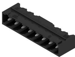
내열성 핀 헤더, 상자 또는 테이프로 포장됨. 자동 조립에 최적화된 1.5 mm 용접 핀의 테이프 형태. 리플로우 및 웨이브 용접에 적합한 3.2 mm 솔더 핀. 핀 헤더는 라벨링을 위한 공간을 제공하며 코딩이 가능합니다. HC = 고전류
